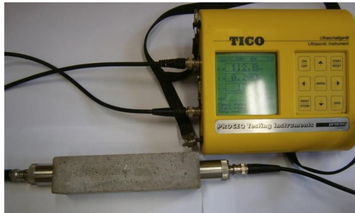
Obr. 15: Měření ultrazvukovou impulzovou metodou
