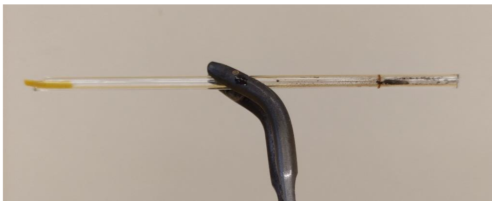
Obr. 40: Negativní reakce zelené tempéry při důkazu dusíku při ~ 10 mg vzorku
