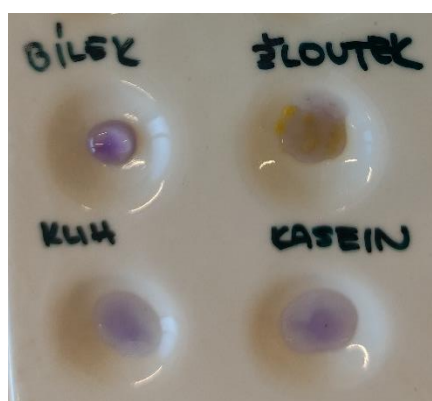
Obr. 19: Výsledek Biuretovy reakce s proteinovými standardy na kapkovací destičce
