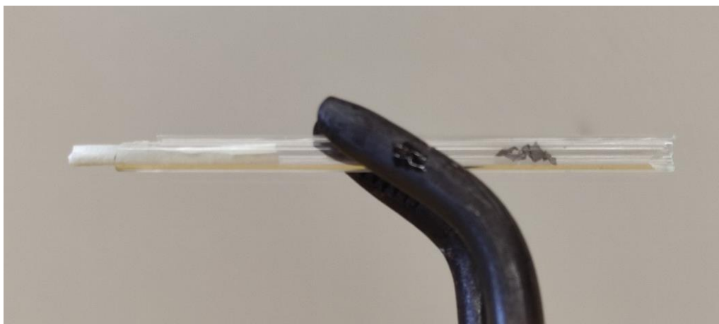
Obr. 41: Negativní důkaz červené tempéry na pyrrolové deriváty při ~ 7 mg vzorku
