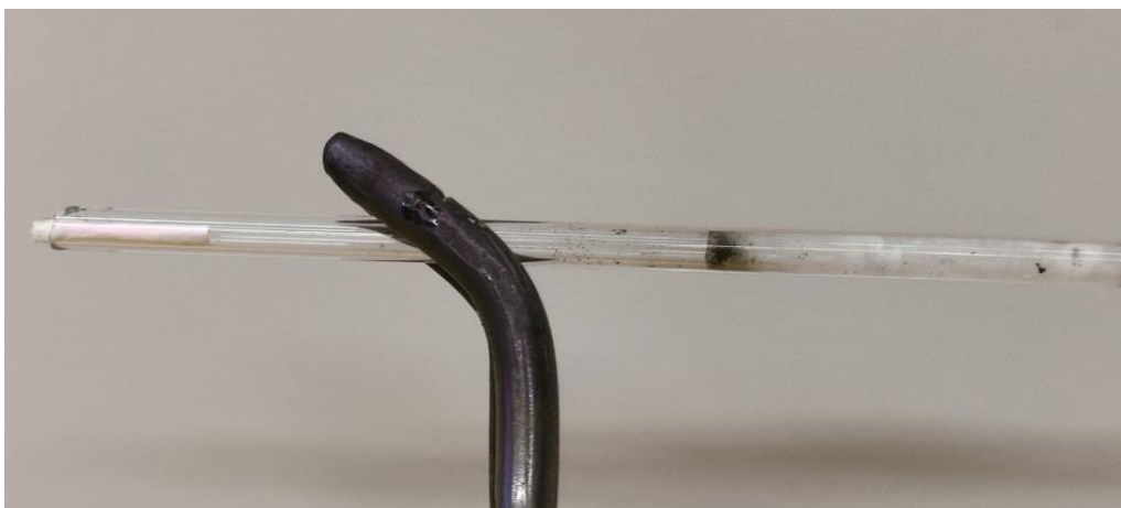
Obr. 34: Pozitivní důkazová reakce na vysychavé oleje ze vzorku č. 4 ~ 3 mg
