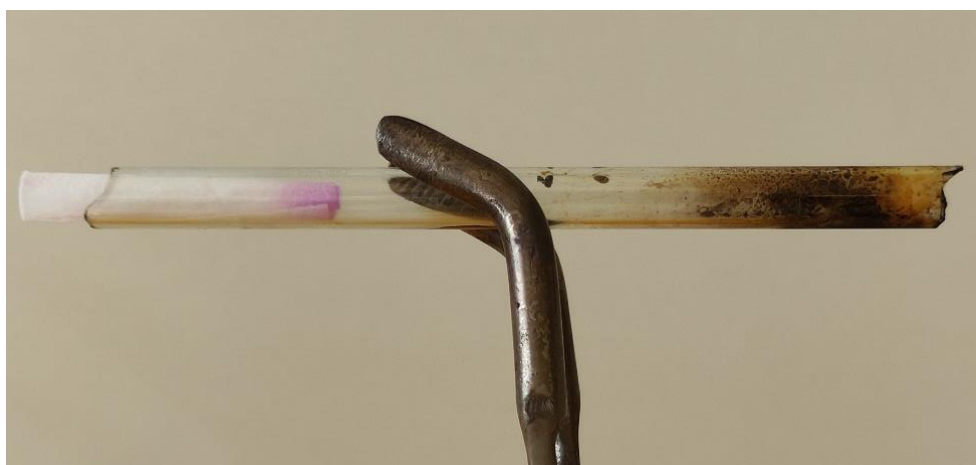
Obr. 28: Pozitivní reakce lněného oleje (znovuzbarvení filtračního papírku s fuchsinem)
