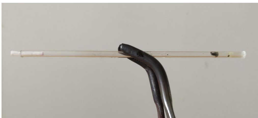
Obr. 55: Negativní důkazová reakce modré akvarely na vysychavé oleje (při ~ 34,1 mg)
