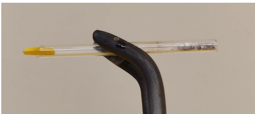
Obr. 51: Negativní důkazová reakce hnědé akvarely na dusík (při ~ 5,4 mg)
