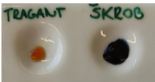
Obr. 17: Důkazová reakce škrobu na kapkovací destičce
