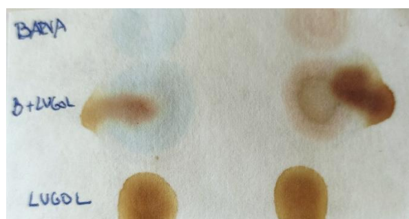
Obr. 59: Negativní reakce akvarelových barev při důkazu škrobu při ~3 mg u modré akvarely a ~4 mg u hnědé akvarely
