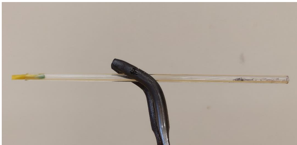
Obr. 36: Výsledek důkazové reakce na dusík u vzorku č. 6 z 5 mg vzorku
