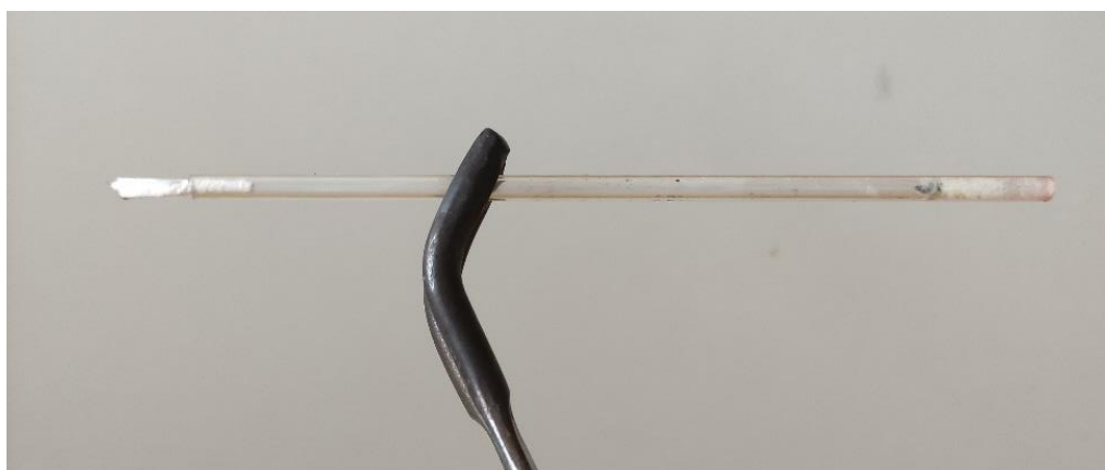
Obr. 56: Negativní důkazová reakce hnědé akvarely na vysychavé oleje (při ~ 54,1 mg)
