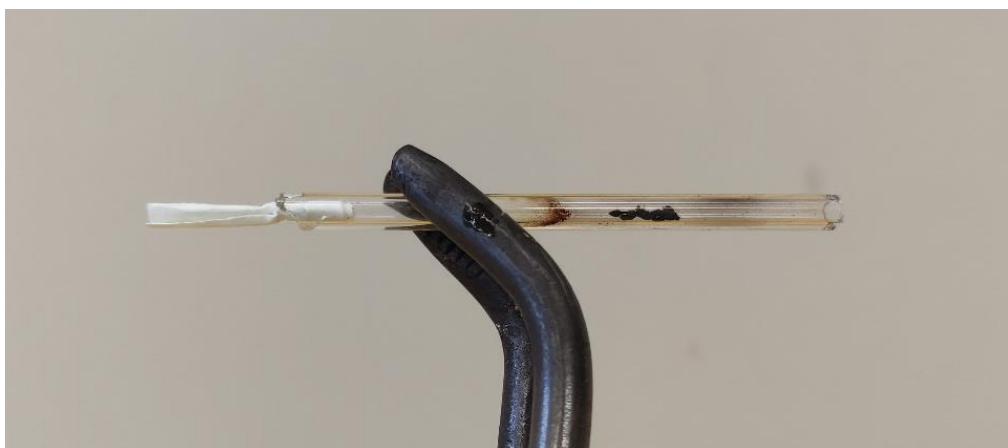
Obr. 52: Negativní důkazová reakce modré akvarely na pyrrolové deriváty (při ~ 30,1 mg)
