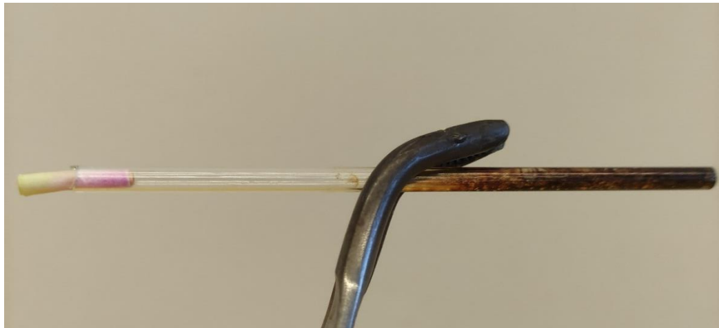
Obr. 24: Pozitivní reakce na pyrrolové deriváty u kaseinu
