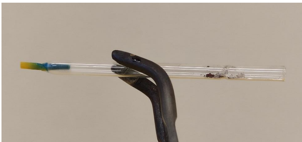
Obr. 50: Pozitivní důkazová reakce modré akvarely na dusík (při ~2,2 mg)
