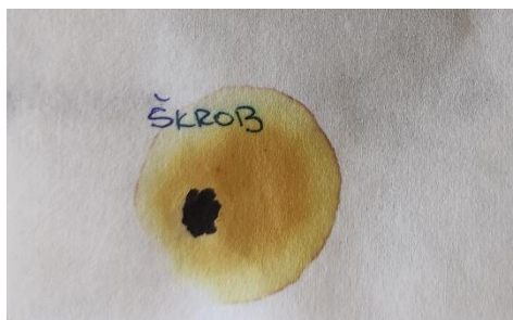
Obr. 18: Důkazová reakce zaschlého škrobu na filtračním papíře
