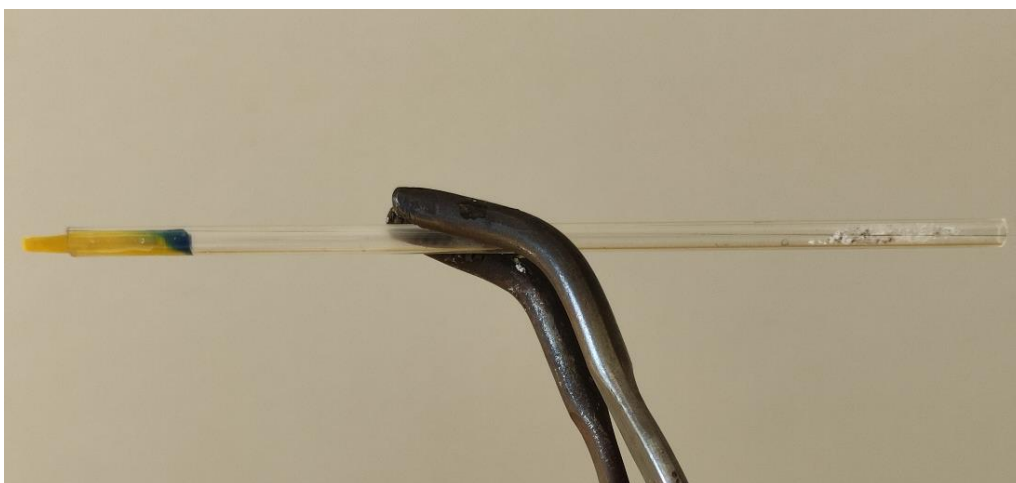
Obr. 32: Pozitivní důkazová reakce na dusík ze žloutkového pojiva vzorku č. 2 ~ 1 mg
