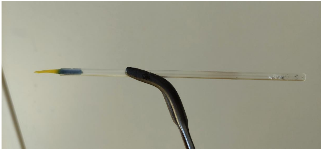
Obr. 23: Pozitivní důkazová reakce na dusík u kožního klišu
