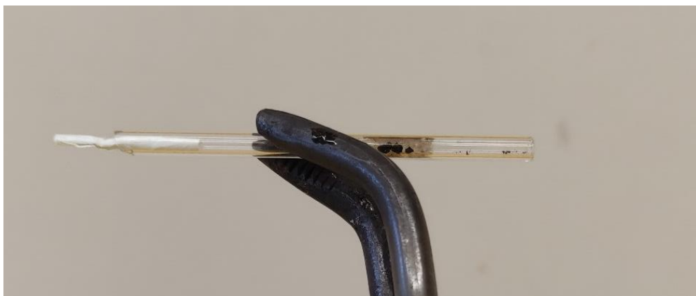
Obr. 42: Negativní důkaz zelené tempéry na pyrrolové deriváty při ~ 9 mg vzorku
