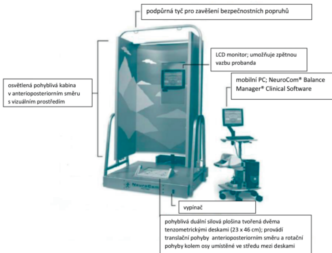
Obrázek 3 Diagnostický a terapeutický přístroj NeuroCom® SMART EquiTest® System (Vomáčková, Pavlů a Pánek, 2020, s. 101)
