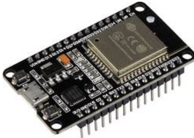
Obrázek 17 Vývojová deska ESP32 [18]
