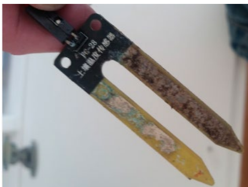
Obrázek 2 Poškozený senzor vlhkosti půdy [30]
