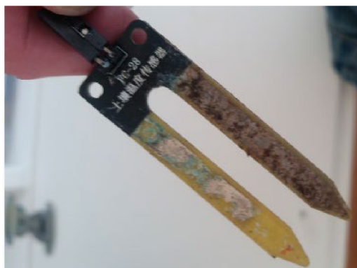
Obrázek 2 Poškozený senzor vlhkosti půdy [30]
