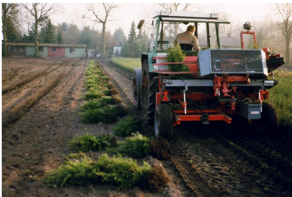
Obr.9: poloautomatický boční vyorávač (PLANTAX ©2024)
