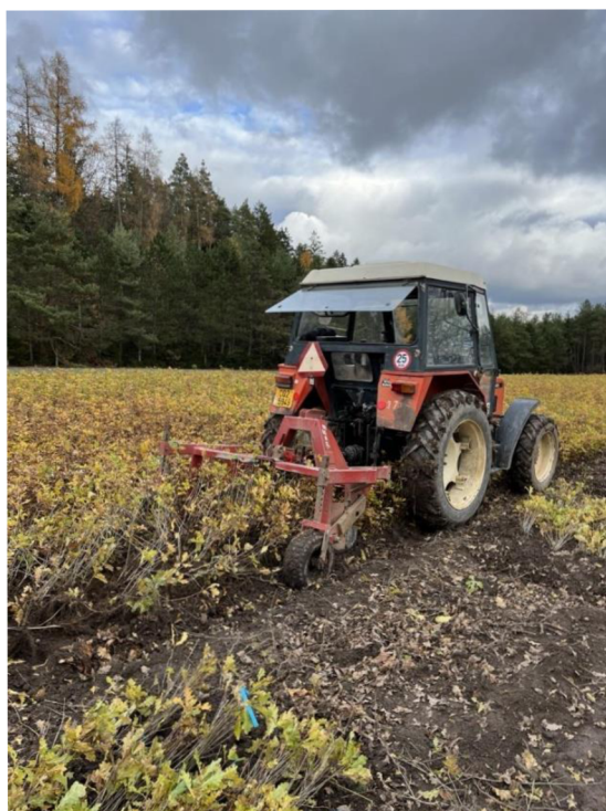
Obr.15: Ukázka mechanizace pro vyzvedávání prostokořenného lesního sadebního materiálu, Planá nad Lužnicí (archiv autora)
