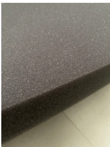
Obr. 42: Akustická černá pěna šíře 4 cm, foto vlastní
