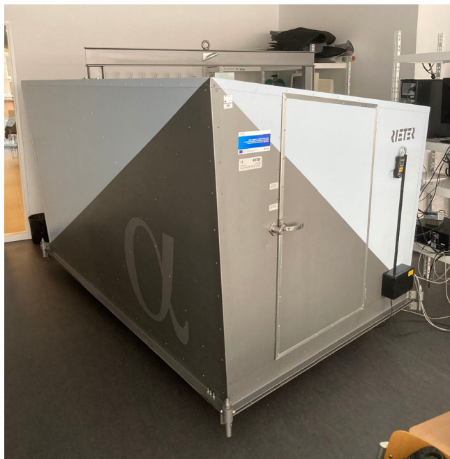
Obr. 44: Alfa kabina pro měření činitele zvukové pohltivosti (Katedra motorových vozidel TUL), foto vlastní
