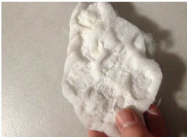
Obr. 36: Polyesterový vzorek vytvořený za pomoci zmuchlané hliníkové fólie a vysoké teploty, foto vlastní
