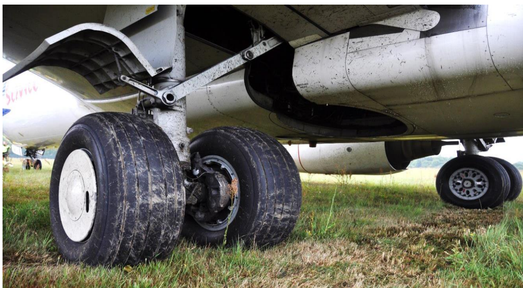
Obrázek č. 16 – Nepoškozený podvozek Boeingu B737-800 při vyjetí z RWY
