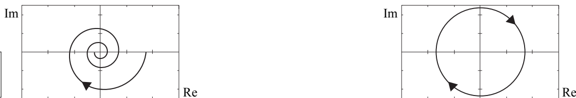
Obrázek 1.4: Nyquistova charakteristika pro proporcionální systém se setrvačností 1. řádu s dopravním zpožděním (vlevo) a samotné dopravní zpoždění (vpravo).
