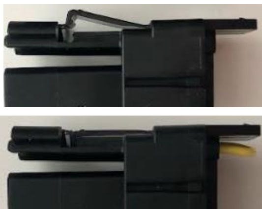
Obrázek č. 34: Těleso s nezacvaklou pojistkou (nahore) a těleso s asemblovaným drátkem a zacvaklou pojistkou (dole) (Zdroj: Vlastní pořizení)
