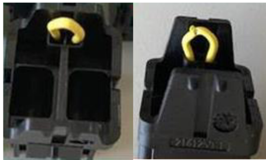
Obrázek č. 29: Nepoškozený drátek (vlevo) a poškozený drátek (vpravo) (Zdroj: Vlastní pořízení)
