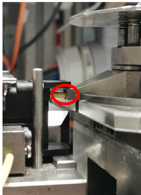
Obrázek č. 30: Místo, kde dochází k poškození drátku (Zdroj: Vlastní pořízení)
