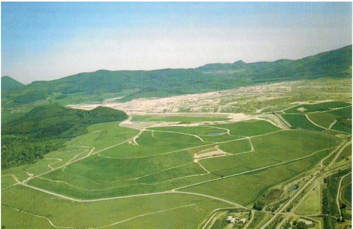
Systém jezírek, poldrů a odvodňovacích příkopů a průlehů je nejlépe zřetelný z leteckého snímku - Radovesická výsypka na Bílinsku
