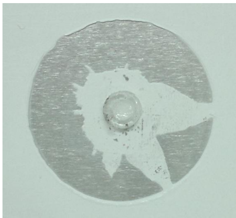
Obr. 51 Detail odtrhové zkoušky
