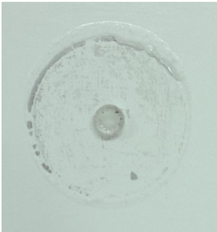
Obr. 52 Detail odtrhové zkoušky
