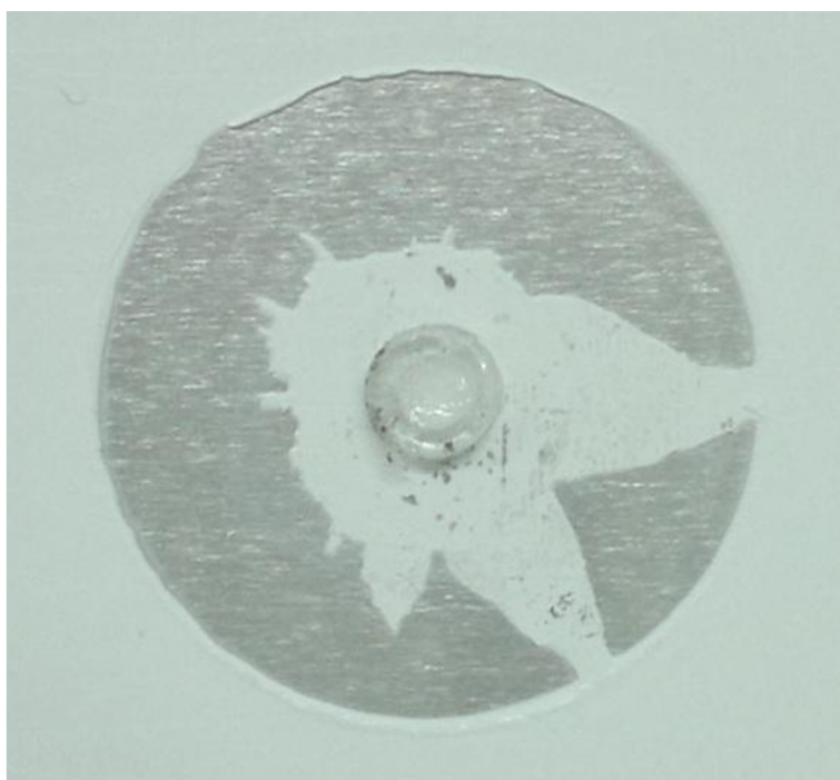
Obr. 51 Detail odtrhové zkoušky
