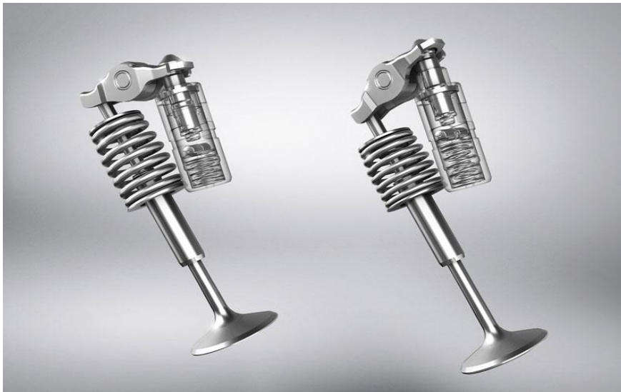
Obr. 17 Vlevo odemčený stav hydraulického členu, odpojený ventil. Vpravo uzamčený stav, ventil v pracovním režimu.
