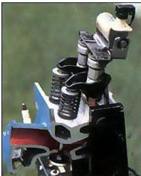
Obr.2 Mechanismus odpojování vahadel Cadillac L62 V8-6-4
