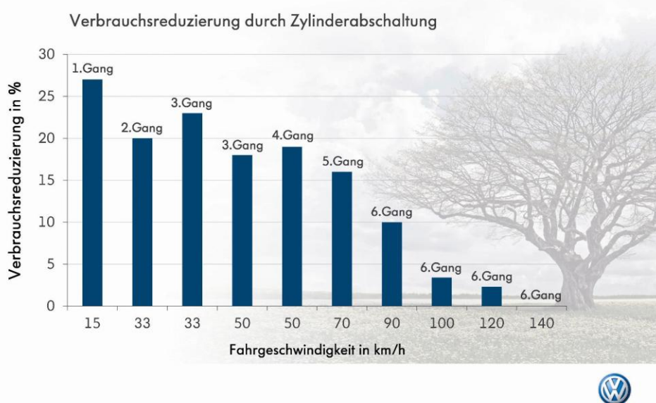
Obr. 21 Graf znázorňující pokles spotřeby při použití systému vypínání válců
