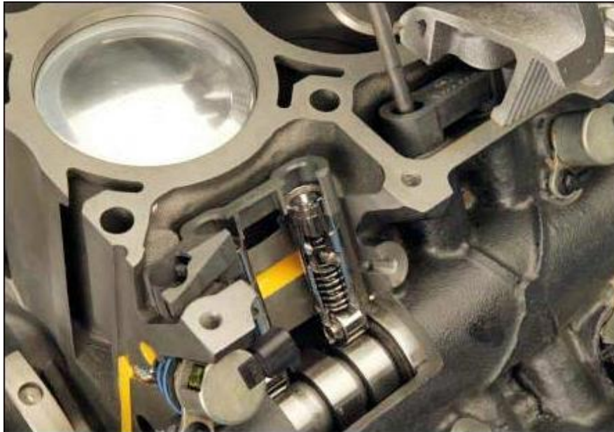
Obr. 9 Detail ventilových zdvihátek u motoru Chrysler 5.7 HEMI se systémem MDS
