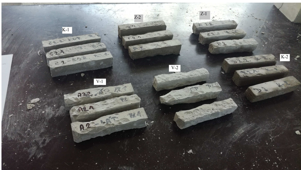
Obrázek 11: Pohled na trámce po zmrazovacích cyklech
