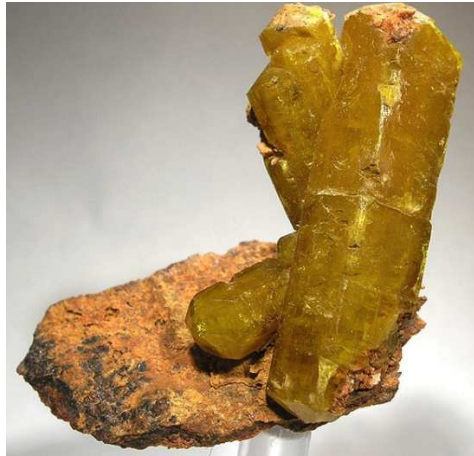
Obrázek 2: Pohled na minerál ettringit [5]
