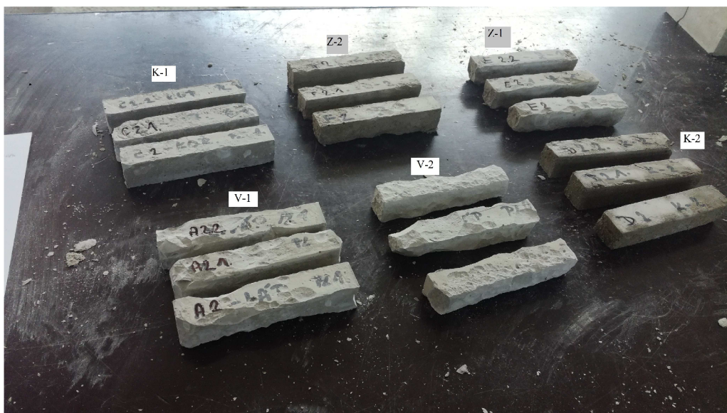
Obrázek 11: Pohled na trámce po zmrazovacích cyklech
