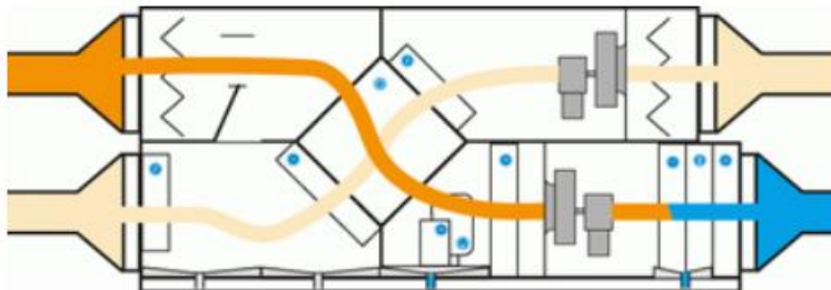
Obr.A. 21 – Upravená bazénová jednotka varianta I. 18
