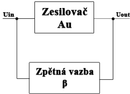
Obr. 4.6 Blokové schéma zpětnovazebního oscilátoru
