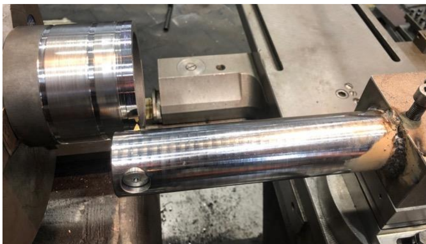
Obr. 4.3 Přivaření přípravku k přípravku nožového držáku.
