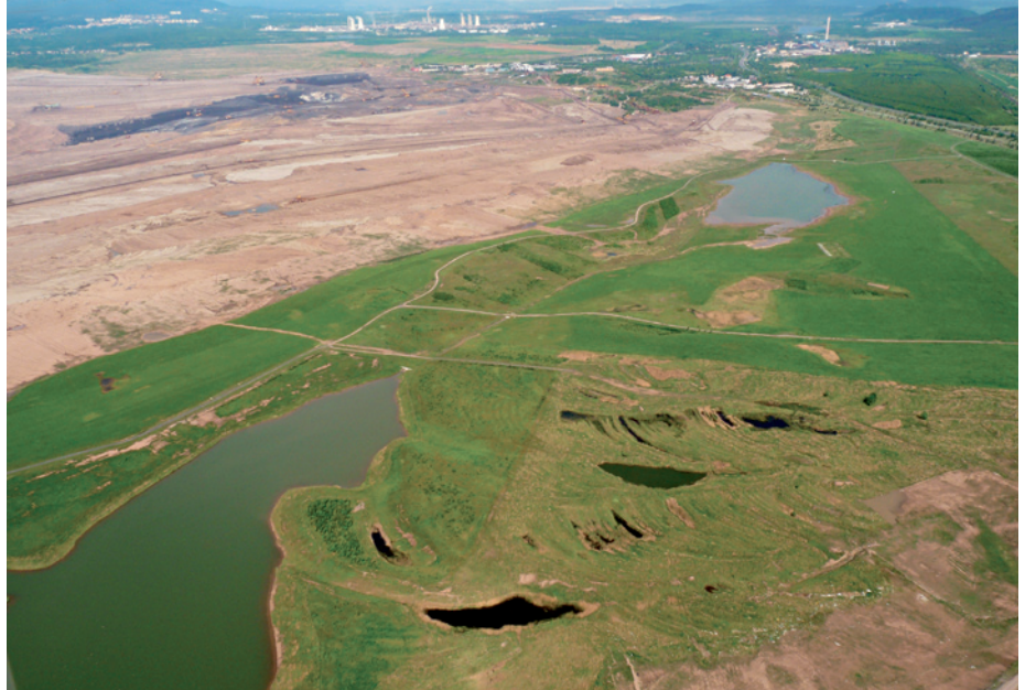
Obr. 5 Mírný sklon a větší členitost břehů velkých vodních ploch umožní rychlé vytvoření litorálního pásma a vznik mělkých partií oddělených od volné vodní hladiny. Ponechaná spontánně vytvořená nebeská jezírka v okolí mohou využívat druhy citlivé vůči zarybnění. Vnitřní výsypka velkolomu ČSA
