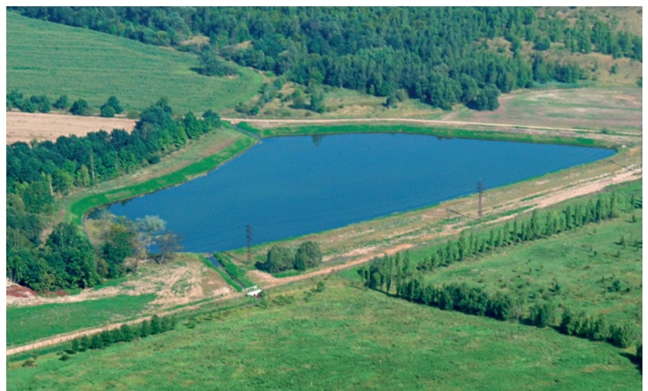
Obr. 4 Vodní plochy zakládané na rekultivovaných výsypkách jsou charakteristické větší rozlohou a hloubkou, pravidelným tvarem, zpevněnými a příkrymi břehy s minimem mělkých a členitých okrajových partií. Doly Nástup Tušimice
