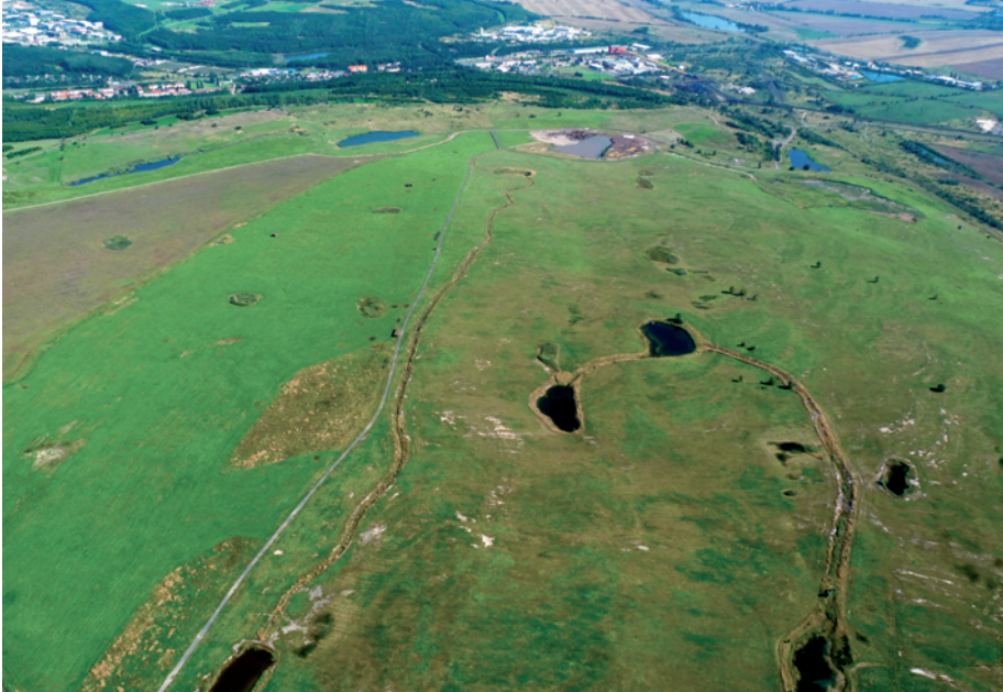
Obr. 3 Množství vodních ploch ponechaných na výspě je adekvátní, chybí však jejich vzájemné propojení s dobře prostupným prostředím. Méně technické provedení odvodňovacích kanálů zajistí vznik liniových mokřadních prvků. Lze také snadno spojit protierozní funkci remízků s funkcemi biokoridorů. Tyto prvky využívají ve špatně prostupném prostředí nejen obojživelníci, ale i jiné druhy živočichů. Statinická výsypka
