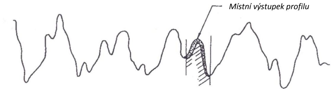
Obr. 39 Místní výstupek profilu
