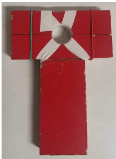
Obrázek 5.1.3.: Provizorní držák pro zářiče
