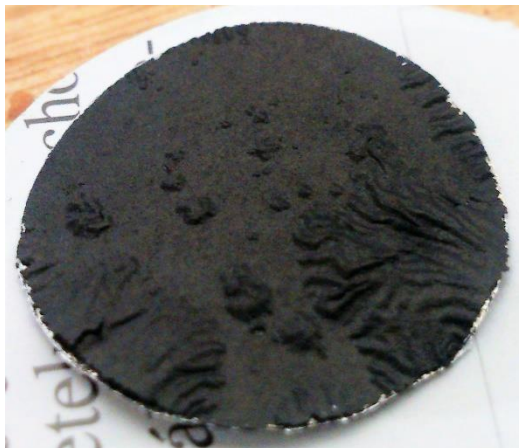
Obr. 36 Fotografia použitej elektródy po zalisovaní 10 tonami (1624 kg/cm 2 )
