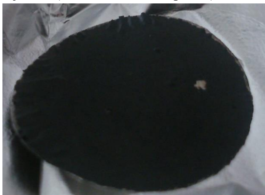
Obr. 24 Fotografia použitej elektródy po zalisovaní 5 tonami (812 kg/cm 2 )
