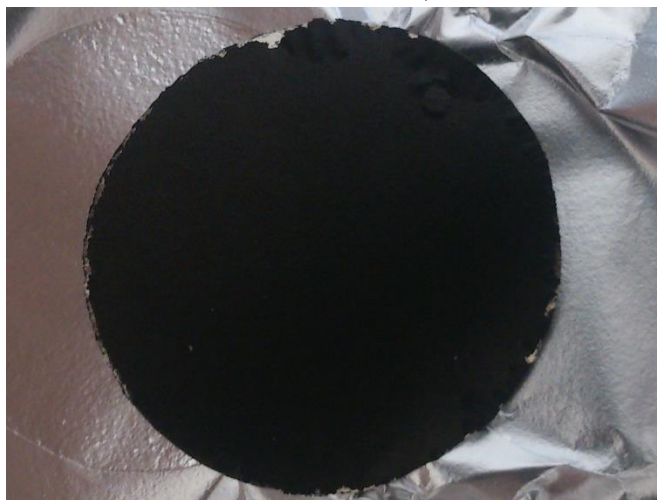
Obr. 30 Fotografia elektródy lisovanej tlakom 7,5 tony (1218 kg/cm 2 )
