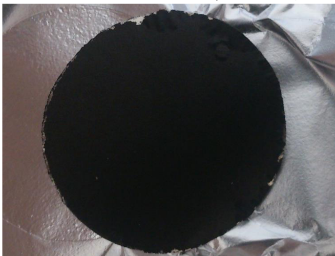
Obr. 30 Fotografia elektródy lisovanej tlakom 7,5 tony (1218 kg/cm 2 )
