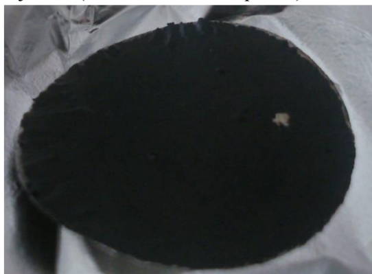
Obr. 24 Fotografia použitej elektródy po zalisovaní 5 tonami (812 kg/cm 2 )
