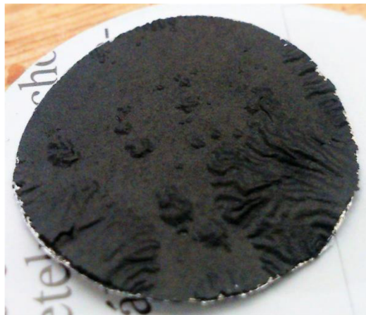
Obr. 36 Fotografia použitej elektródy po zalisovaní 10 tonami (1624 kg/cm 2 )
