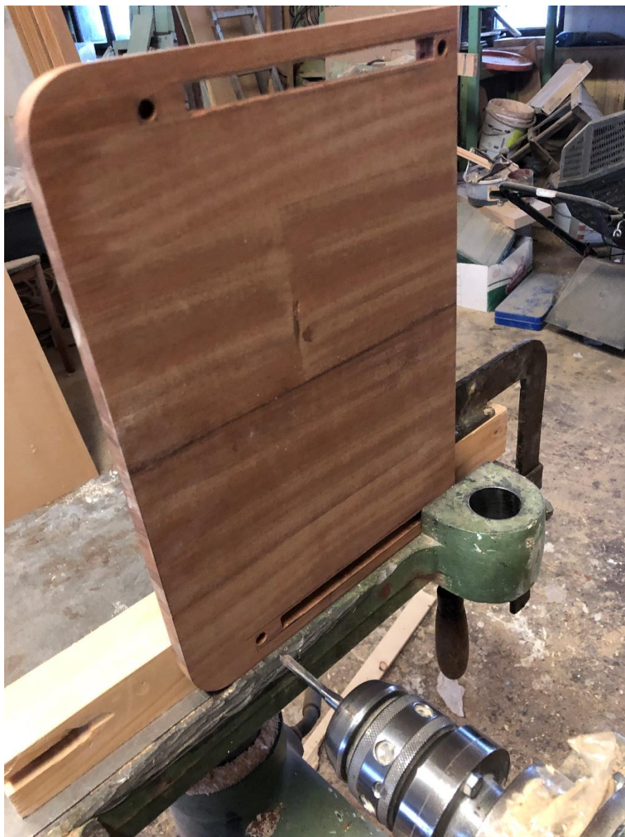
Obrázek 32 Částečné vrtání otvorů pro kolíky
