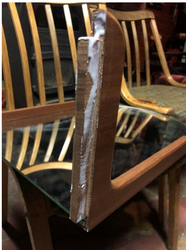
Obrázek 49 Nanesení dostatečného množství pro slepení částí
