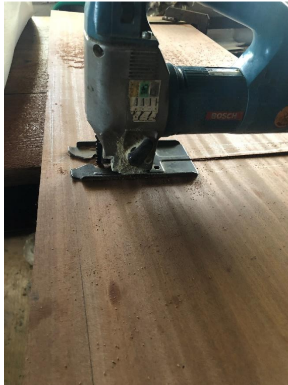
Obrázek 11 Řezání přímočarou pilou
