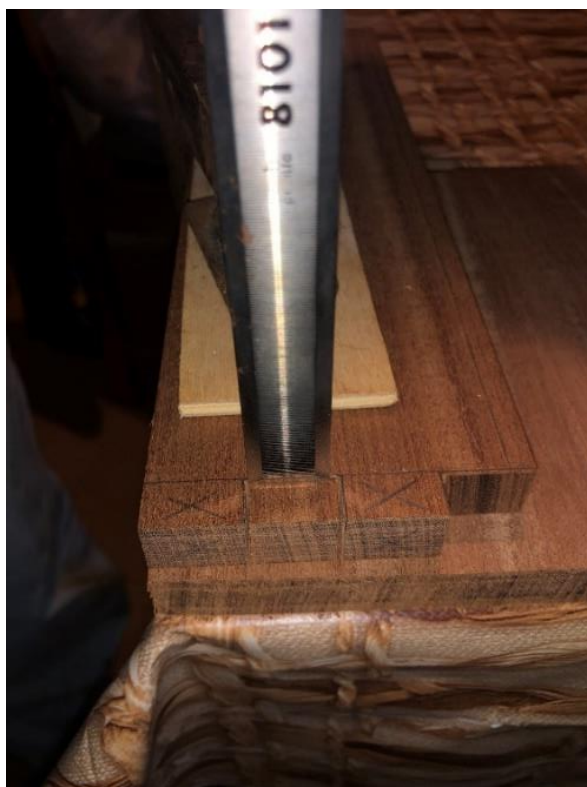
Obrázek 24 Vydlabávání ozubů 1. část
