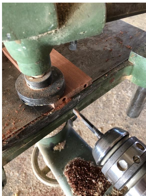
Obrázek 21 Detailní pohled na vrtání otvorů pro kolíky
