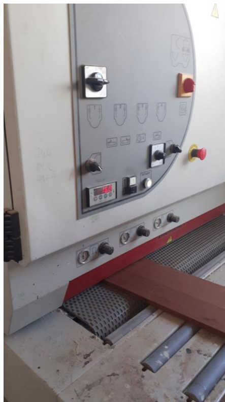
Obrázek 6 Broušení širokopásmovou bruskou na přesný rozměr
