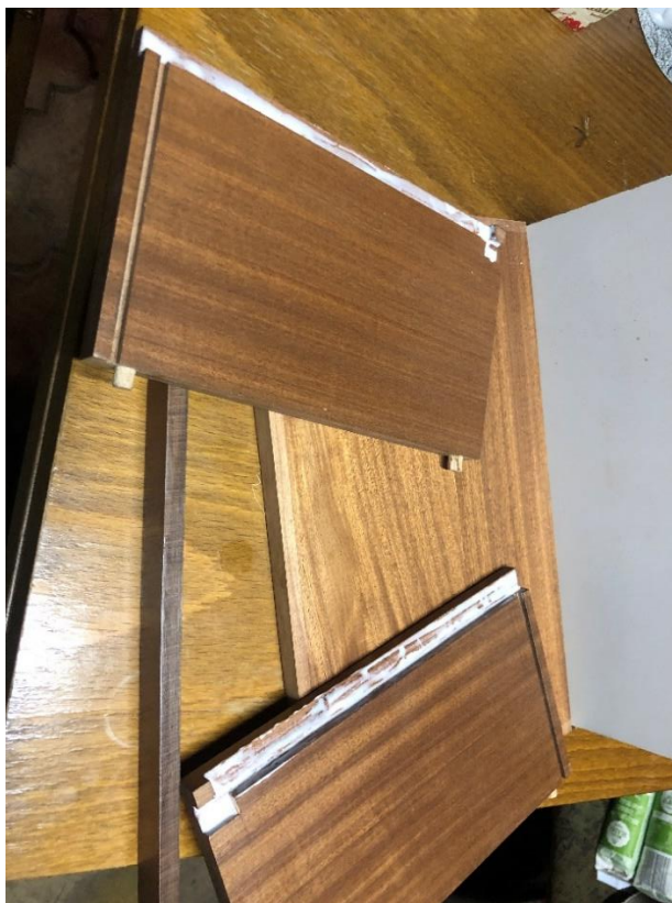
Obrázek 51 Lepení spodního dílu
