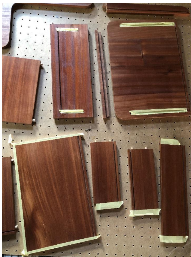
Obrázek 46 Olepení hran, které budou spojované lepidlem
