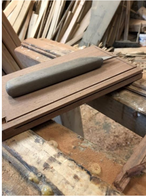
Obrázek 37 Dořezávání drážky určené pro zasazení dna
