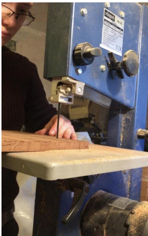
Obrázek 12 Řezání na pásové pile
