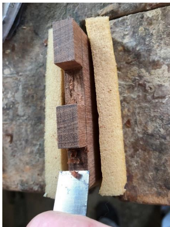
Obrázek 26 Vydlabávání ozubů 3. část
