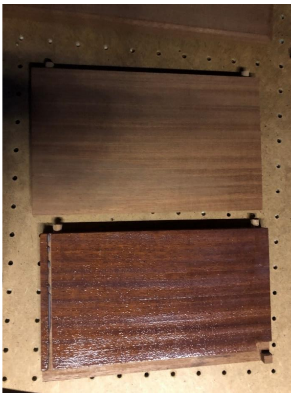
Obrázek 44 Rozdíl mezi první vrstvou a surovým materiálem
