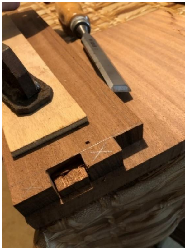
Obrázek 25 Vydlabávání ozubů 2. část
