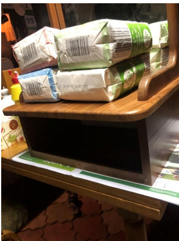
Obrázek 52 Konečné slepení spodního dílu pro šuplík a vrchního dílu hlavní plochy s bočnicemi a zrcadlem
