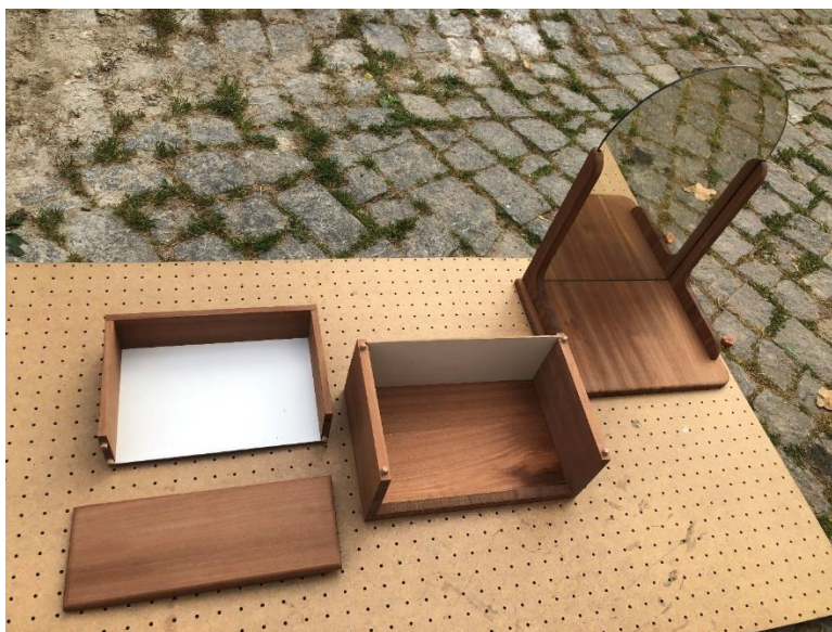
Obrázek 41 Poslední zkouška sesazení před povrchovou úpravou
