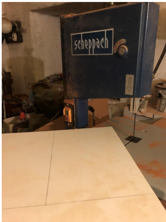
Obrázek 35 Řezání dna šuplíku a zad spodního dílu zrcadla (sololak)
