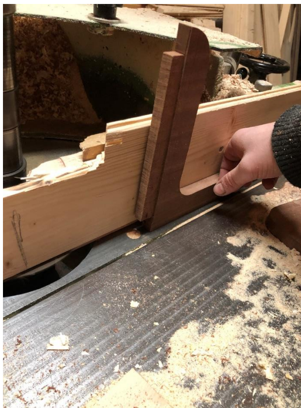
Obrázek 34 Frézování drážky pro zrcadlo
