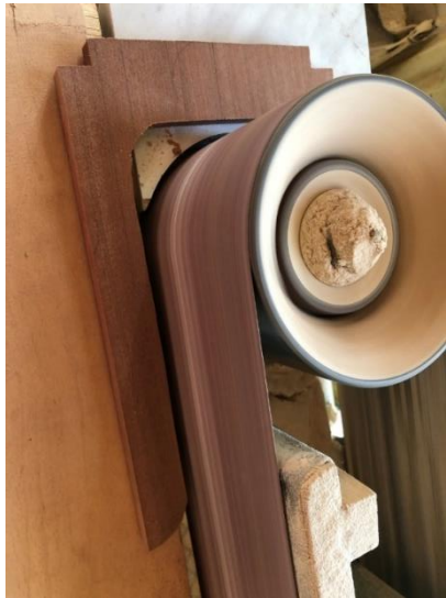
Obrázek 15 Částečné broušení bočnic
