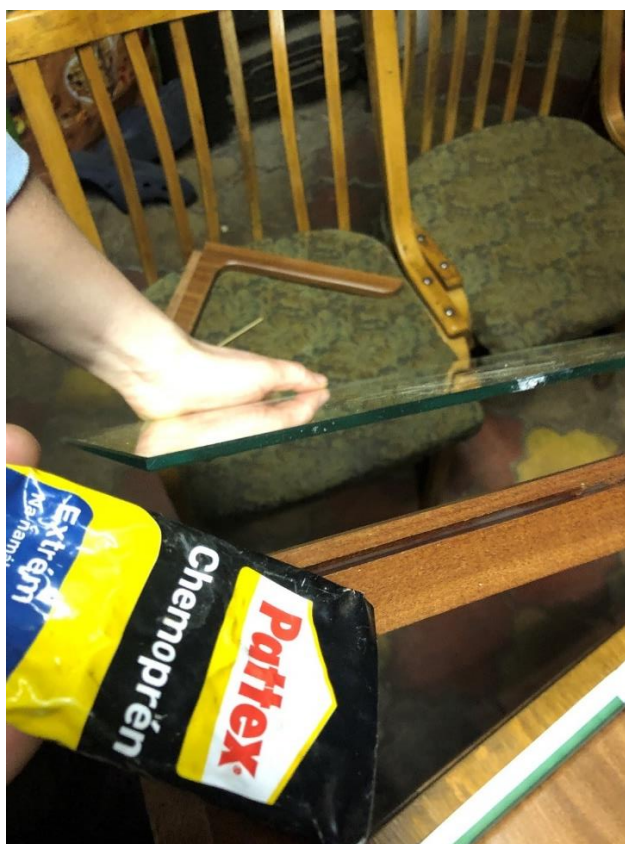
Obrázek 48 Lepení zrcadla do bočnic
