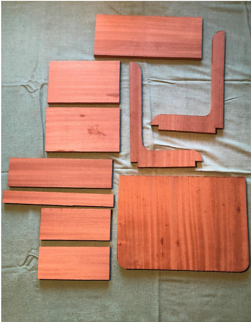
Obrázek 13 Nařezaný materiál na zrcadlo s nadmírou na opracování
