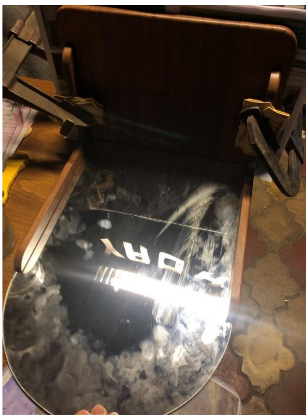
Obrázek 50 Lepení zrcadla s bočnicemi do hlavní plochy
