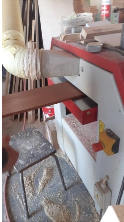
Obrázek 4 Protahování (hoblování) nahrubo
