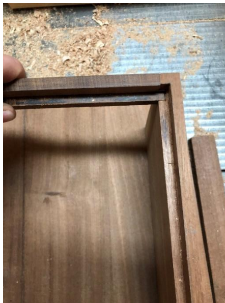
Obrázek 38 Zkouška příčky spojující bočnice (čep a dlab)
