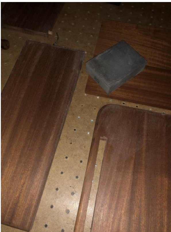
Obrázek 45 Broušení ořepů po zaschnutí první vrstvy
