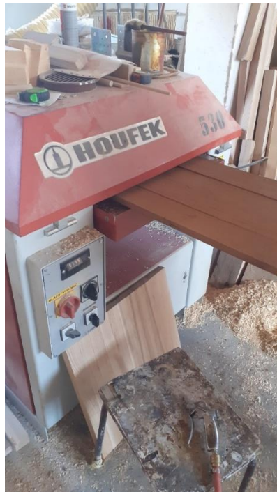
Obrázek 5 Protahování (hoblování) dohladka
