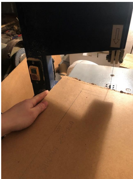
Obrázek 9 Vyřezávání šablony na zrcadlo
