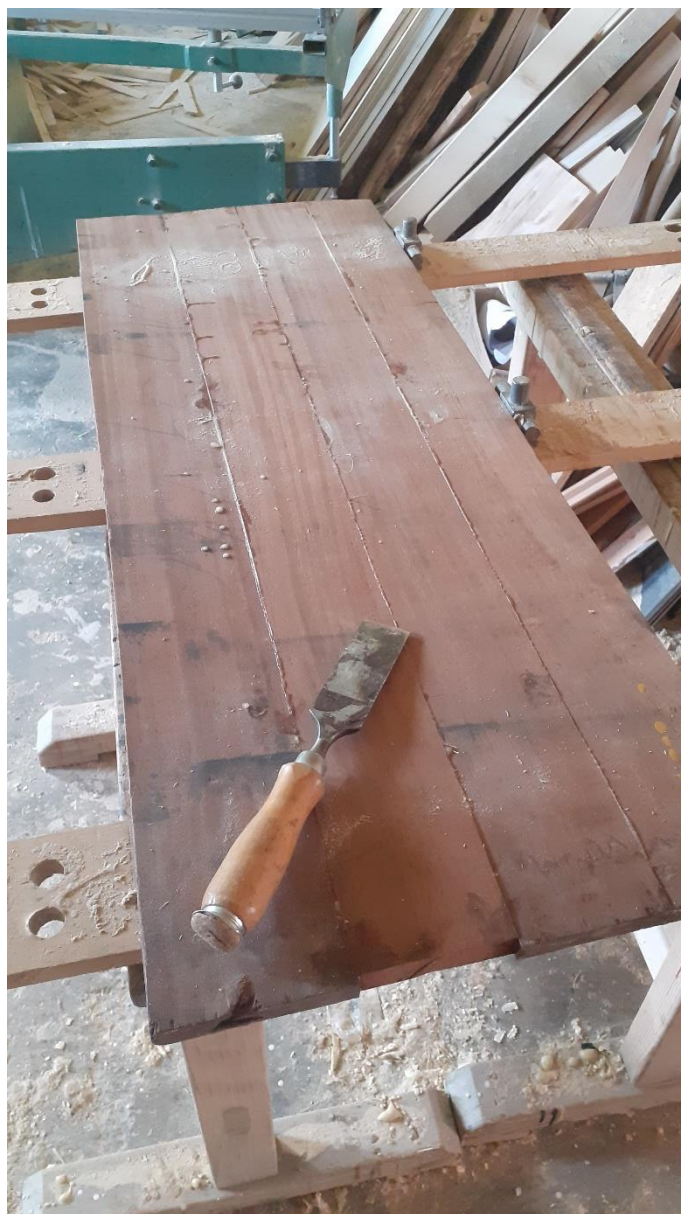
Obrázek 3 Začištění spárovky před hoblování a protahováním
