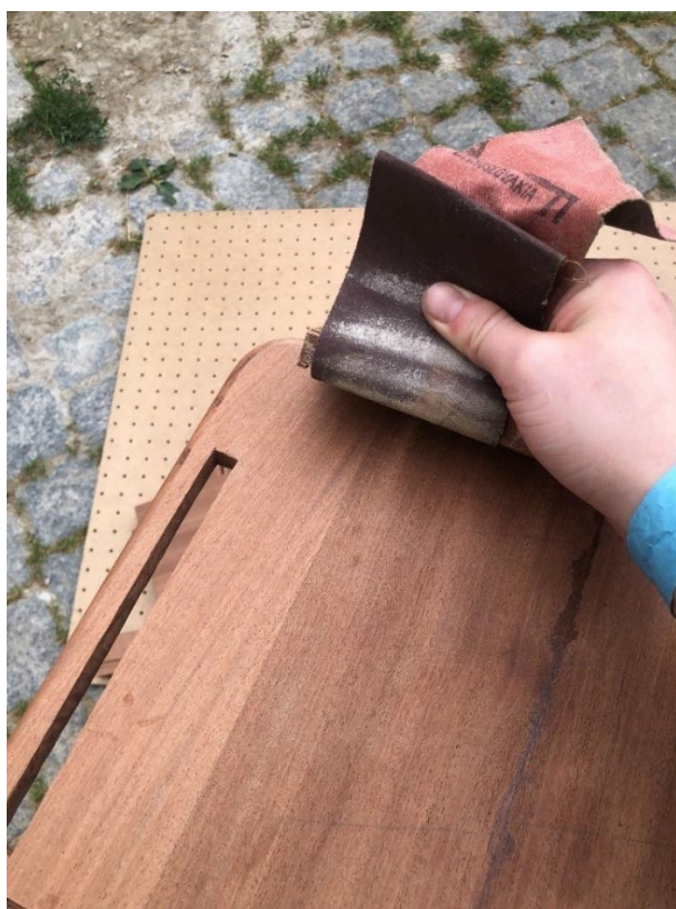
Obrázek 40 Broušení dílů před povrchovou úpravou
