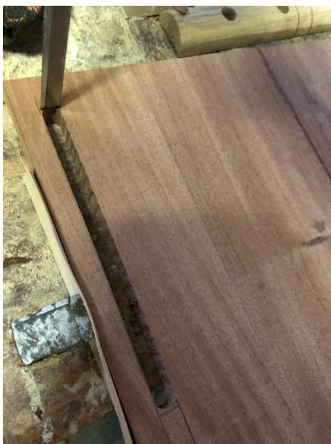
Obrázek 30 Dodlabávání (dlabu) pro čep bočnice
