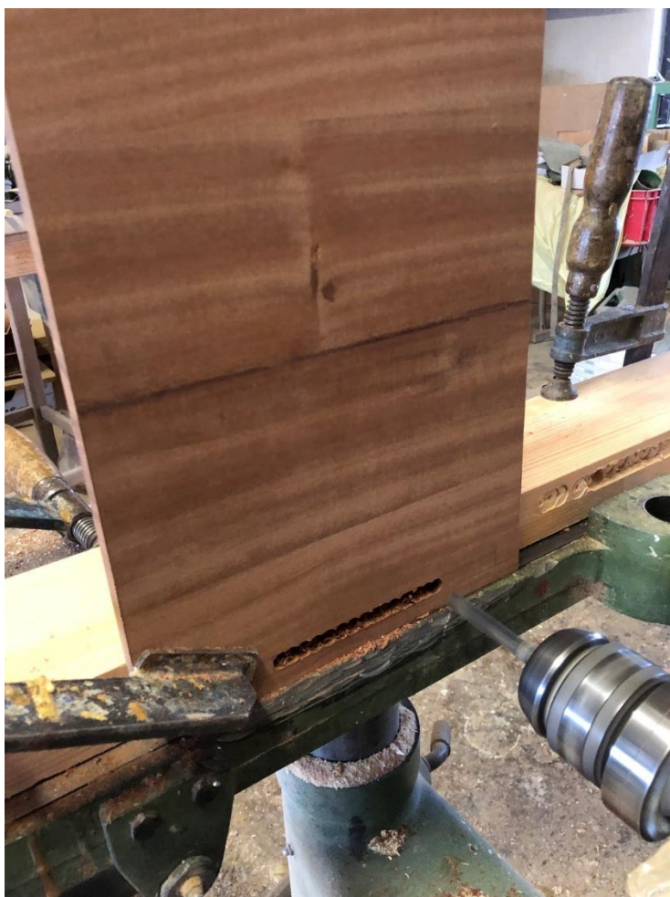
Obrázek 19 Vrtání dvoupákovou dlabačkou do hlavní desky
