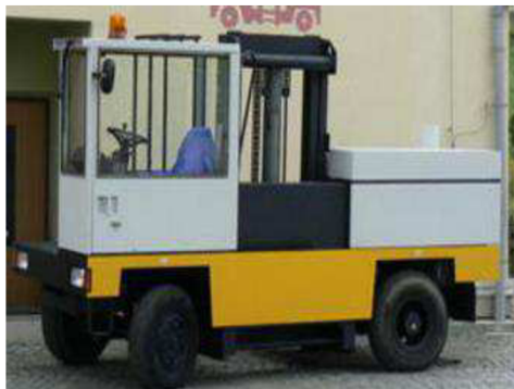
Obr. 2.6 Boční vysokozdvížený vozík Transporta. [13]
