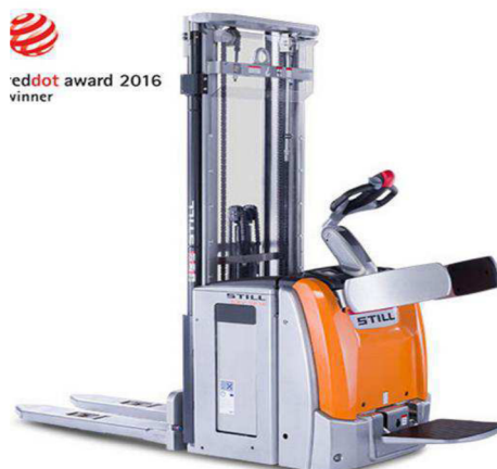
Obr. 2.8 Ručně vedený vysokozdvížený vozík STILL. [18]
