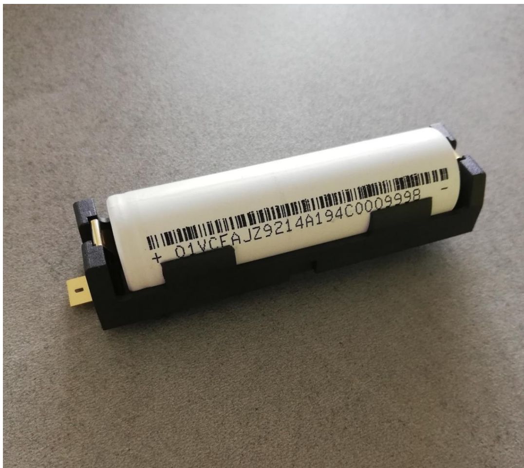
Obr. 3.5: Článek MH1 v držáku na baterie
