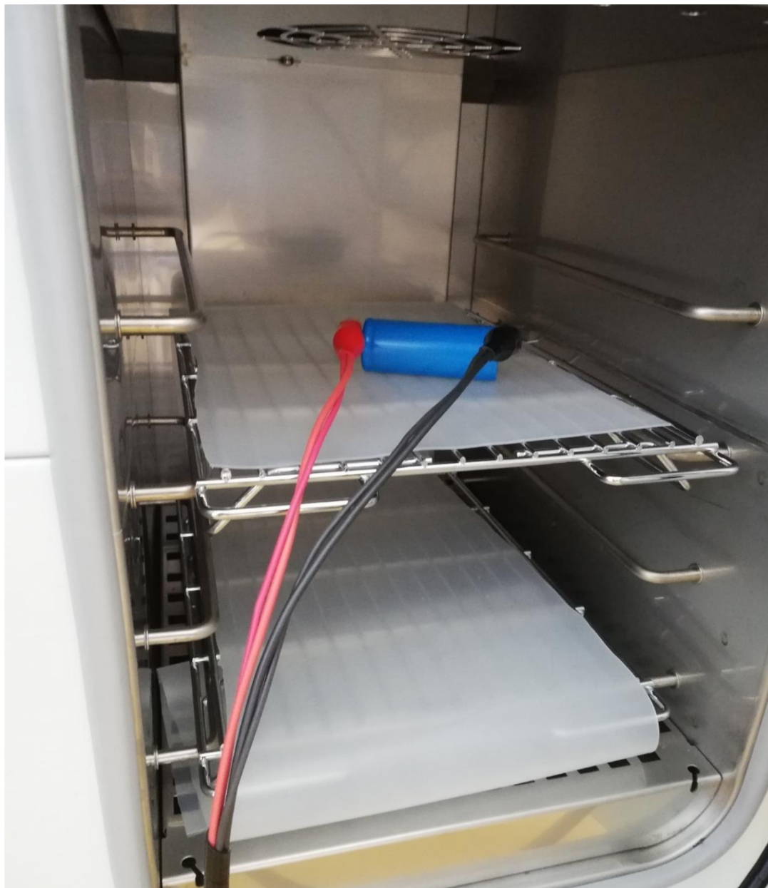
Obr. 3.4: Nabodovaný a zapojený článek LFP před zahájením měření při 45 °C
