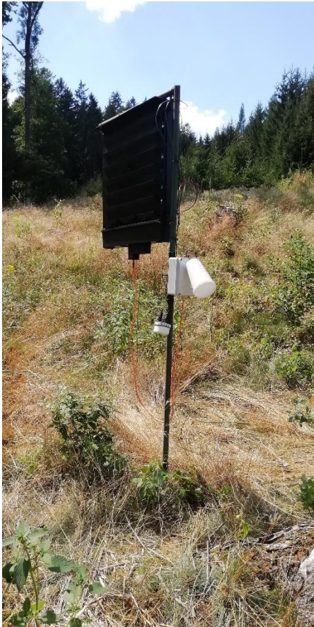
Obrázek č. 3: Automaticky feromonový lapač, na kterém jsou vidět připojené senzory ve spodní části (Richter, 2022).
