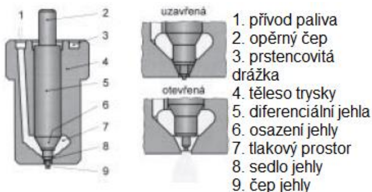
Obr. 3.20. Řez čepovou vstříkovací tryskou [20]
