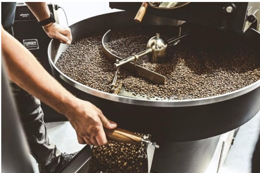
Obrázek 28: Chlazení zrn v profesionální bubnové pražičce kávy [96]
