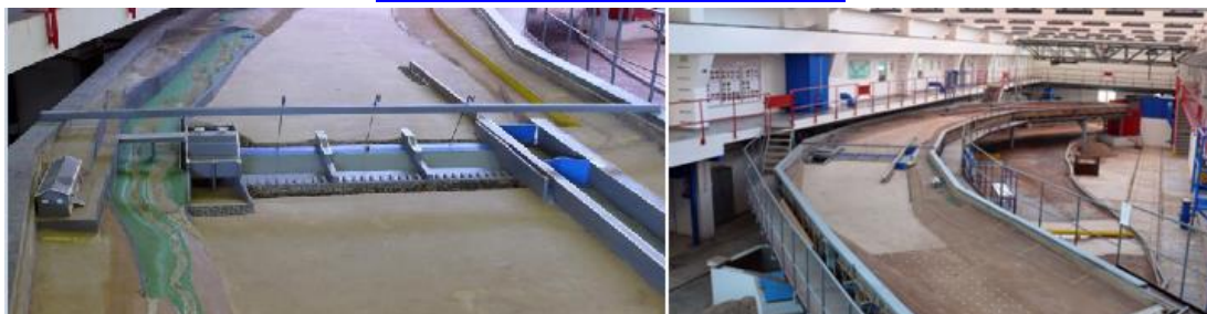
Obrázek 31 Hydraulický model plavebního stupně Děčín – var. 1a – v měřítku 1:70
