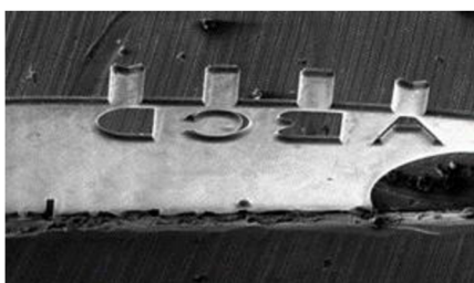
Obrázek č. 49: Příprava měděné sítky – na jeden z „prstíků“ se tlustší lamela přivaří
