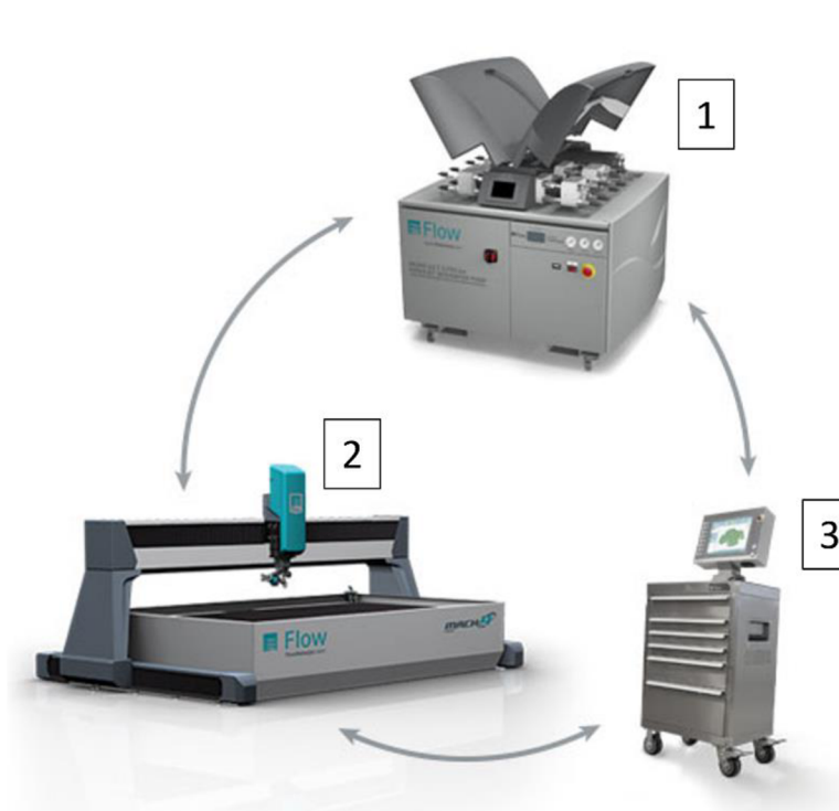
Obrázek č. 17: Systému pro technologii vodního paprsku: zdroj vysokého tlaku (1); pracovní stůl s řezací hlavou (2); řídicí systém (3) [22]
