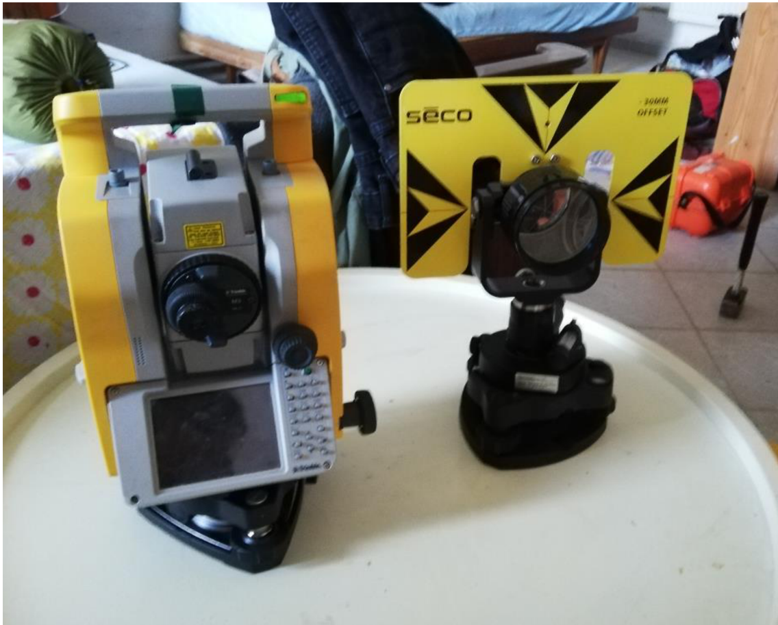
obr. 8 Totální stanice Trimble M3 s odrazným hranolem na třínožce
