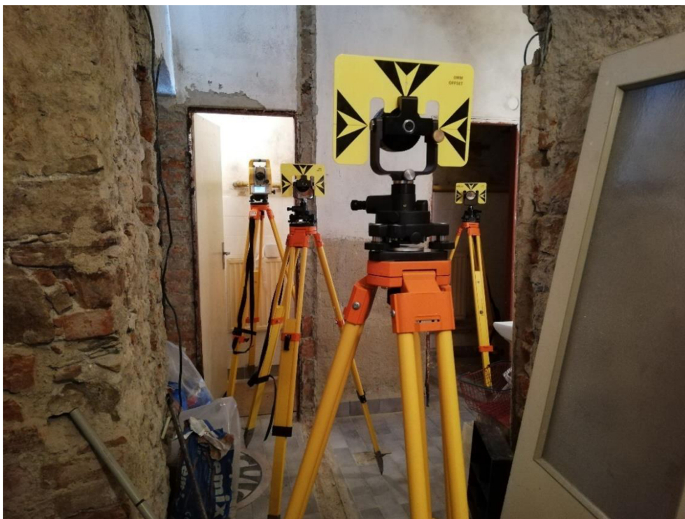
obr. 4 Měření pomocné měřické sítě
