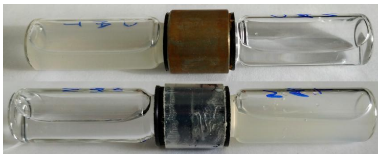
Obr. 5 Rozdělovací aparatura – nahoře s kovovým pouzdem, dole s plastovým
