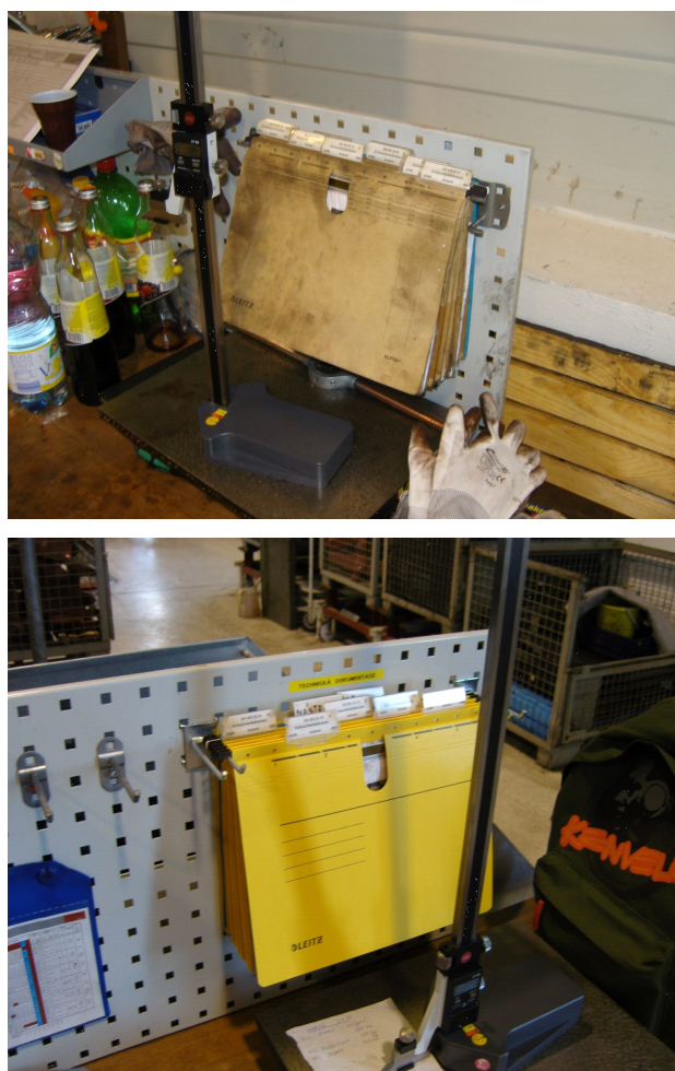
Obrázek 8 - Aktualizace a popis výkresové a technické dokumentace před a po zavedení 5S
