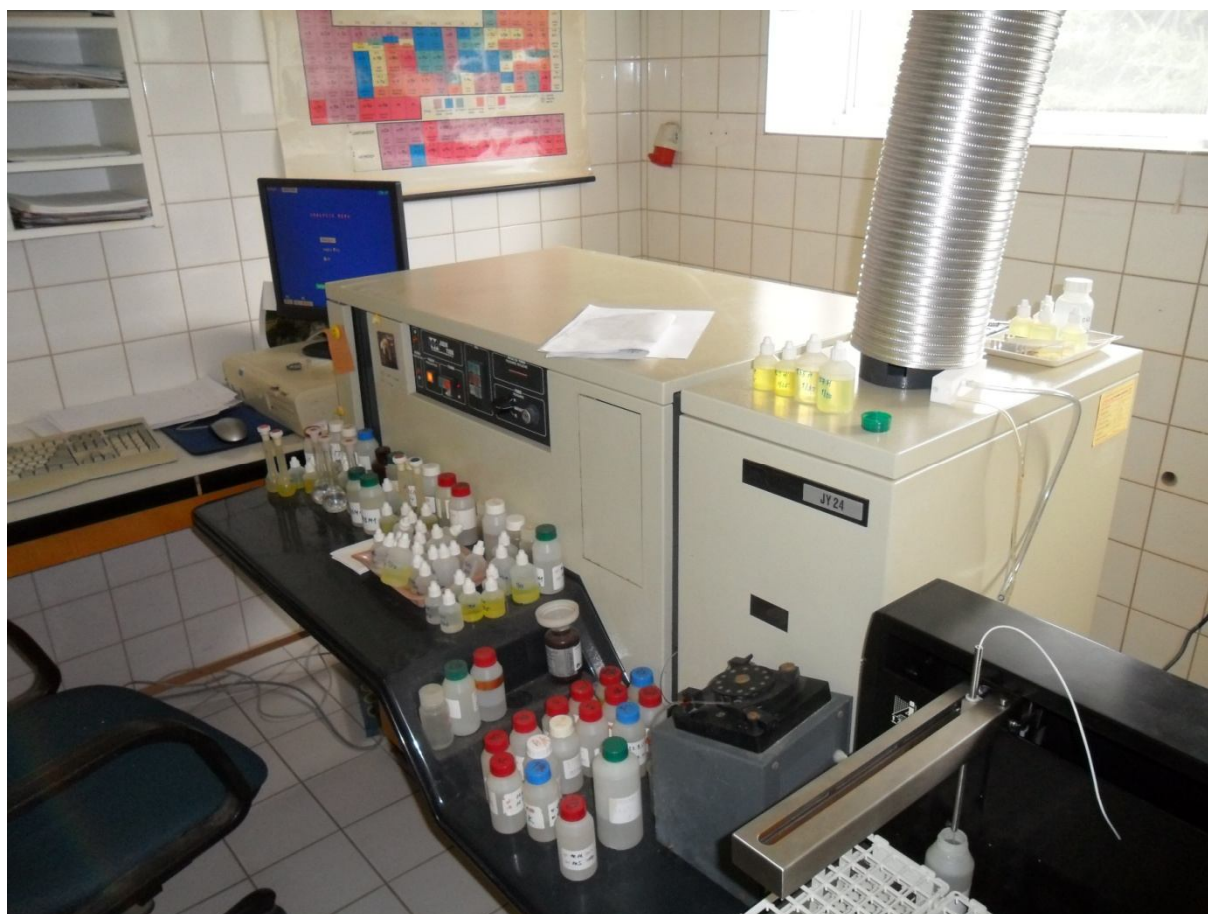
Obr. 12 ICP – OES (spektrofotometr s indukčně vázaným plazmatem)
