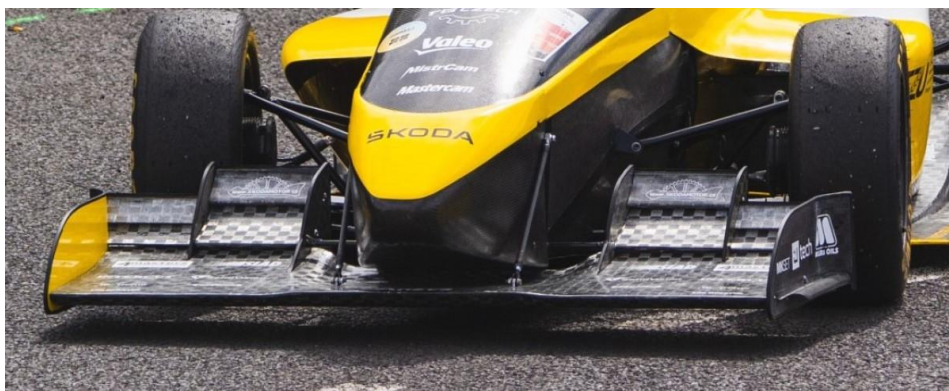
Obrázek 12 – Přední přítlačné křídlo FS.08 (archiv CULS PFR)
