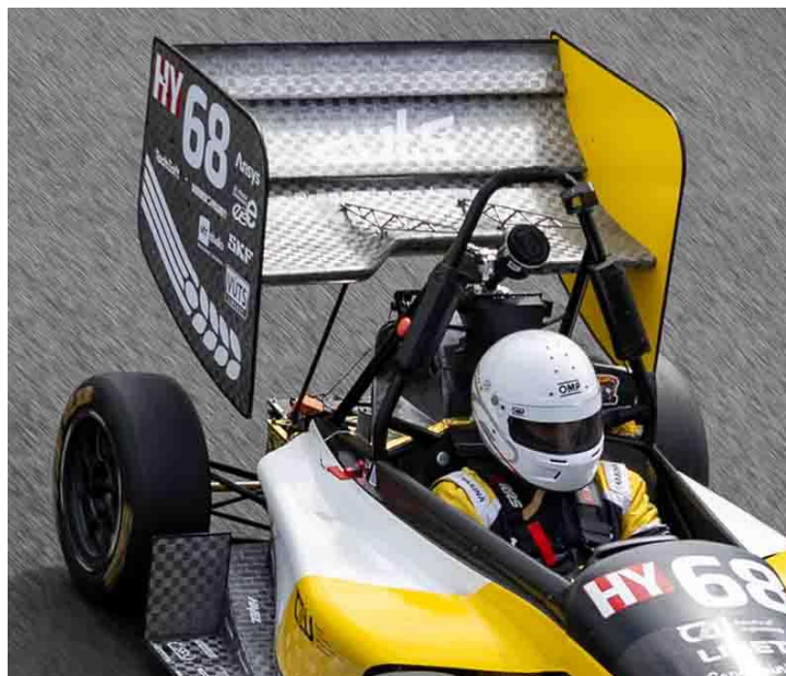
Obrázek 15 – Zadní přitlačné křídlo FS.08 (archiv CULS PFR)
