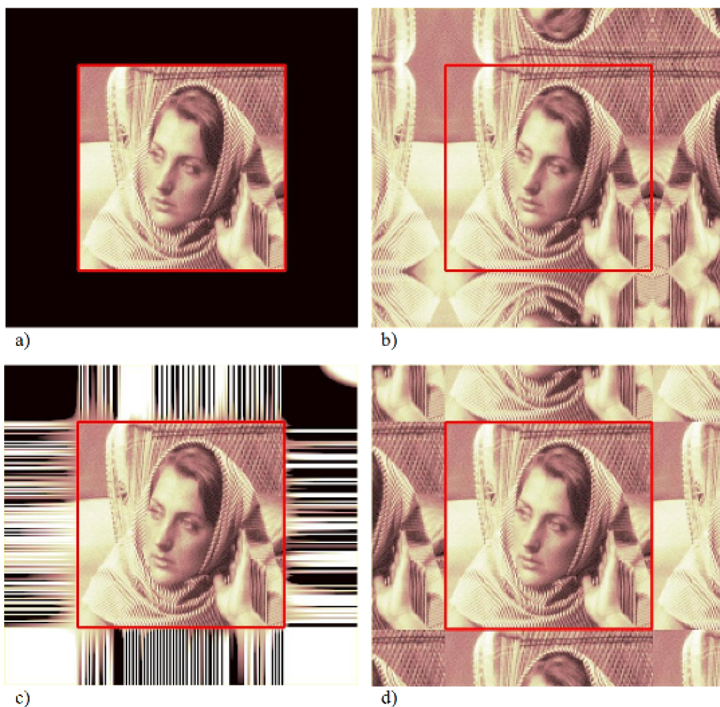
Obr. 2.2: Testovací obraz a jeho prodloužení na okrajích v programu MATLAB: a) doplnění nulami, b) symetrické prodloužení, c) prodloužení polynomem, d) periodizace
