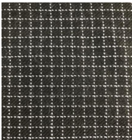
Obrázek 15: Vzorek tkaniny s elektricky vodivou mřížkou
