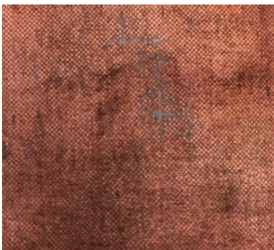
Obrázek 28: Vzorek netkané pokovené textilie
