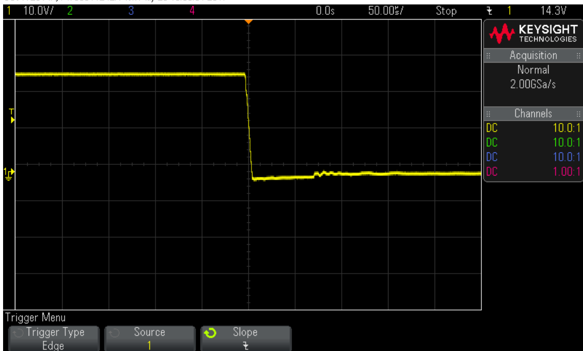
Obr. 4.2. Sestupná hrana výstupního napětí budiče elektromotoru.
