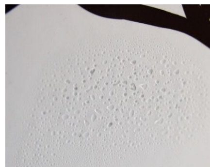
Obr. 22 Puchýře na povrchu [34]
