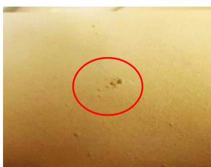
Obr. 26 Na výrobku se tvoří hrudky [34]
