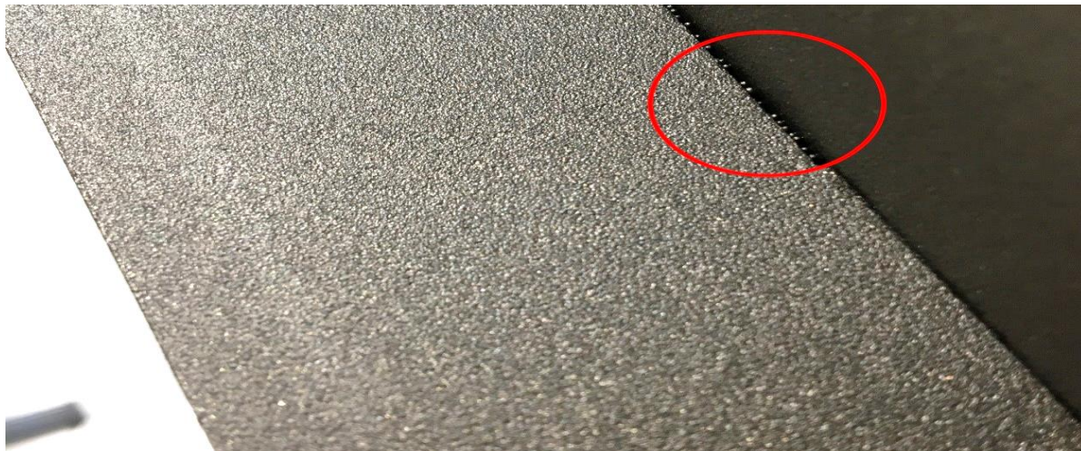
Obr. 32 Povrch po otryskání se zbytky abraziva
