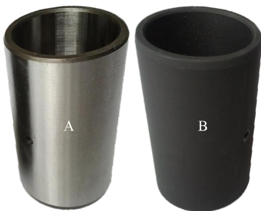
A) povrch před B) povrch po úpravě Obr. 5 Manganaté fosfátování [13]
