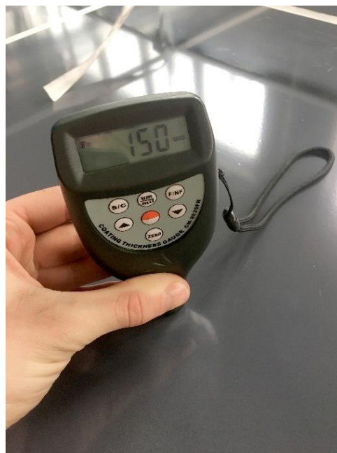
Obr. 37 Měření tloušťky laku pomocí tloušťkoměru CM 8825
