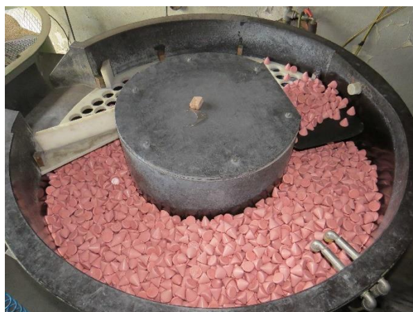
Obr. 3 Omílací buben s plastovými tělisky [11]
