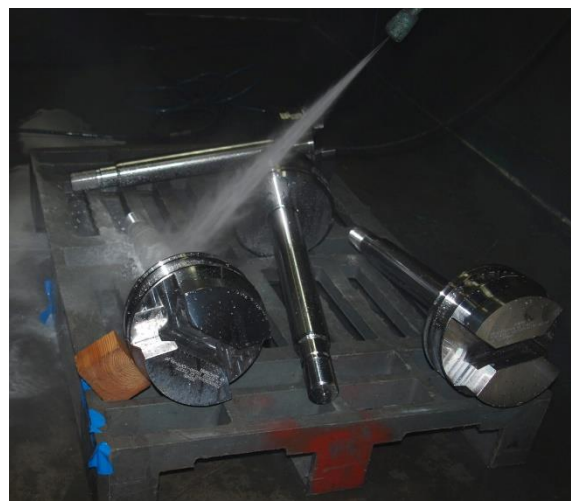
Obr. 4 Alkalické odmašťování ruční metodou [6]
