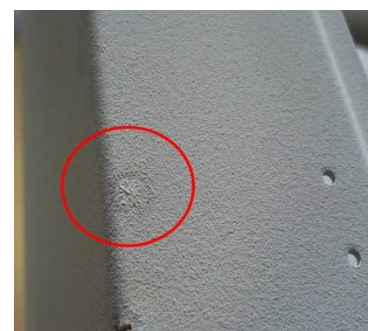
Obr. 27 Odskakování barvy z výrobku [34].
