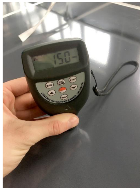
Obr. 37 Měření tloušťky laku pomocí tloušťkoměru CM 8825
