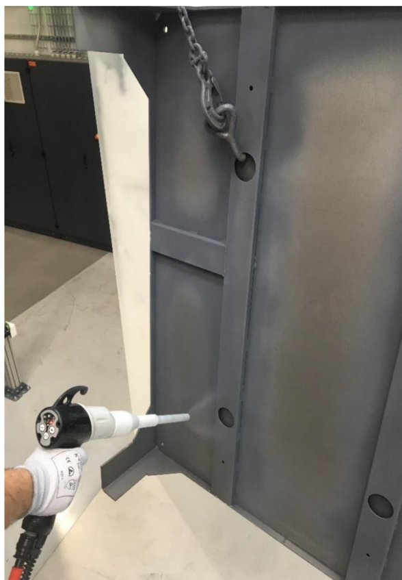
Obr. 34 Předstřík výrobku ruční pistolí
