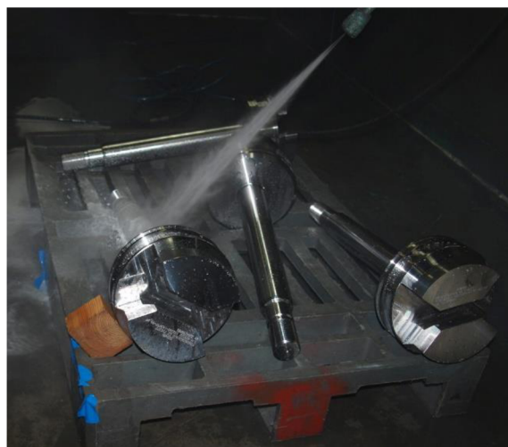
Obr. 4 Alkalické odmašťování ruční metodou [6]
