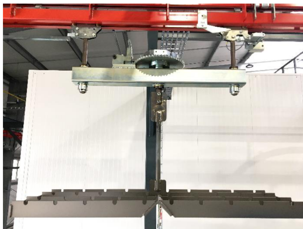
Obr. 19 Power & Free dopravník
