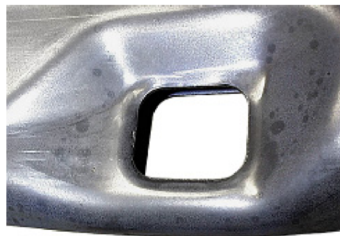
Obr. 31 Děrování, děrování s lemem, děrování kalibračním tlakem, příklad z praxe [37]
