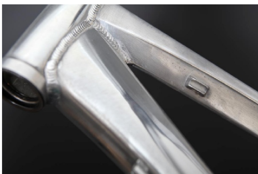
Obr. 24 Produkty vysokotlakého hydroformingu [12], [29]
