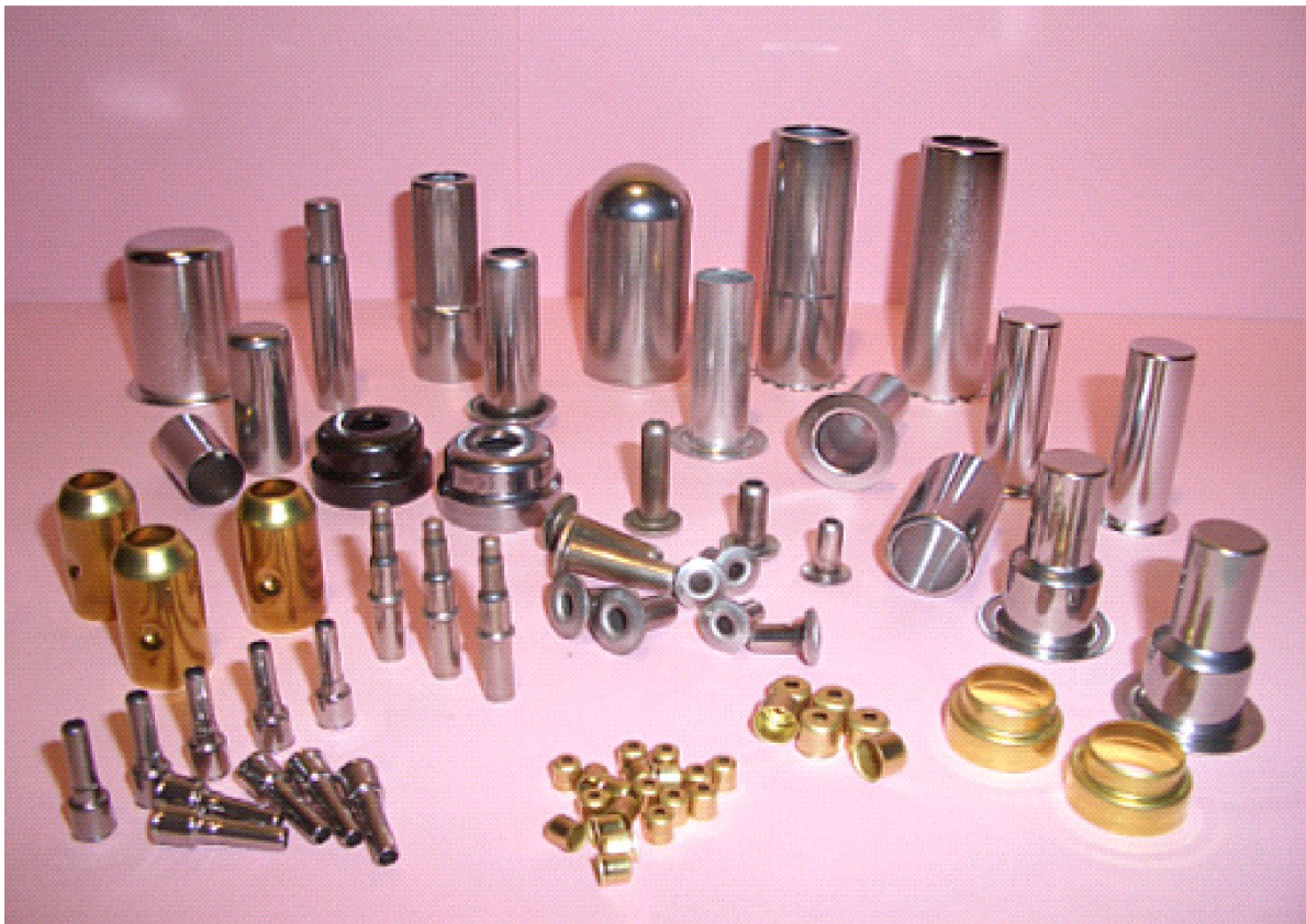
Obr. 16 Výtazky, některé s dodatečně odstraněným lemem [21]
