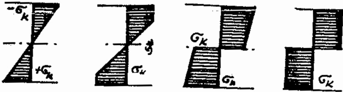
Obr. 2 - Tři pásma v místě ohybu [6] \sigma_k - napětí na mezi kluzu [MPa]
