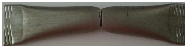
Obr. 17 - Vzorek po zkoušce na tahovém hydraulickém stroji \varnothing 18 x 1,5 mm (původní dodávaný materiál)
