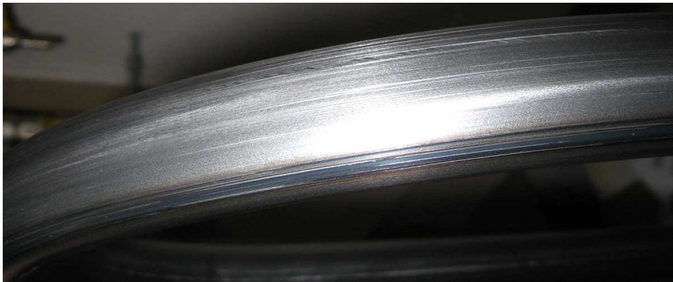
Obr. 14 - Praskliny po ohnutí materiálu
