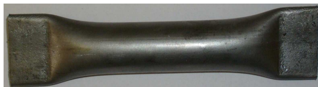
Obr. 18 - Vzorek před zkouškou na tahovém hydraulickém stroji \varnothing 18 x 1,5 mm (současný dodávaný materiál)
