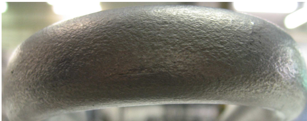
Obr. 15 - Puchýře po ohnutí materiálu
