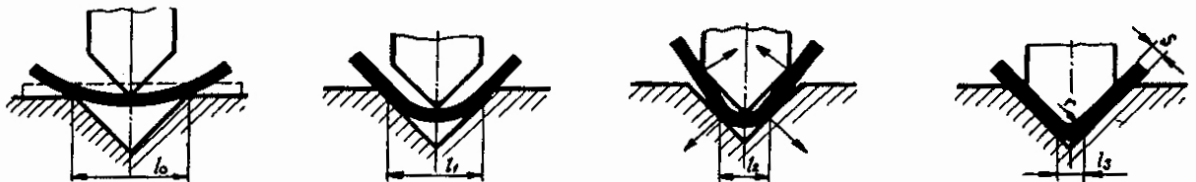
Obr. 4 - Průběh deformace při ohybu do tvaru V [6] l_0 - poměrná délka [mm], r - poloměr [mm], s - tloušťka plechu [mm]
