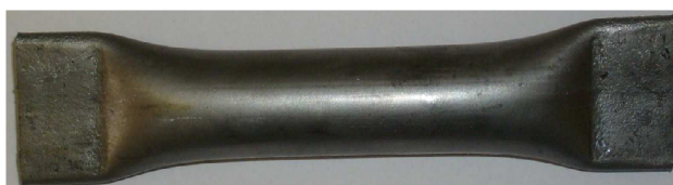
Obr. 18 - Vzorek před zkouškou na tahovém hydraulickém stroji ø 18 x 1,5 mm (současný dodávaný materiál)
