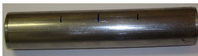
Obr. 20 – Vzorek materiálu před zkouškou na tahovém hydraulickém stroji \phi 26 x 1,2 mm
