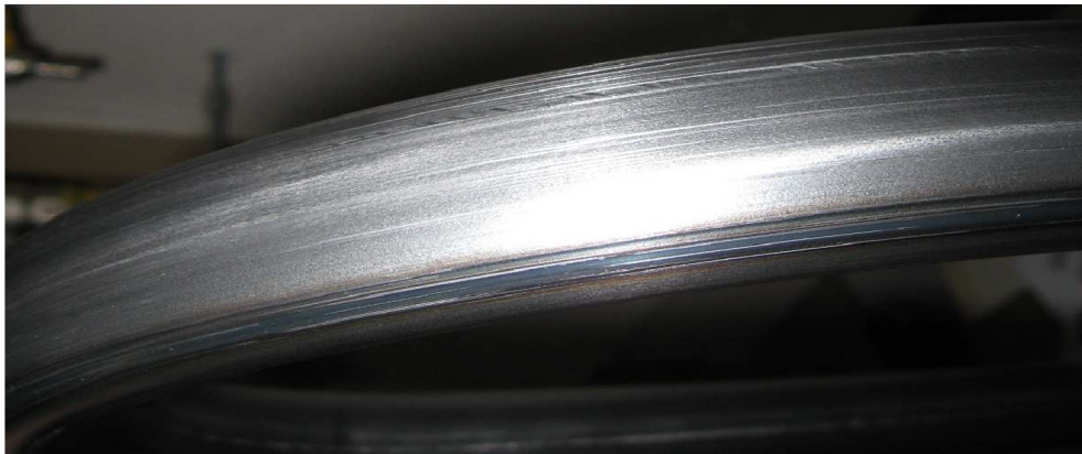
Obr. 14 - Praskliny po ohnutí materiálu
