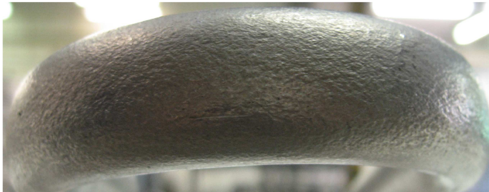
Obr. 15 - Puchýře po ohnutí materiálu
