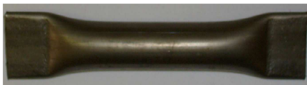
Obr. 16 - Vzorek před zkouškou na tahovém hydraulickém stroji \varnothing 18 x 1,5 mm (původní dodaný materiál)
