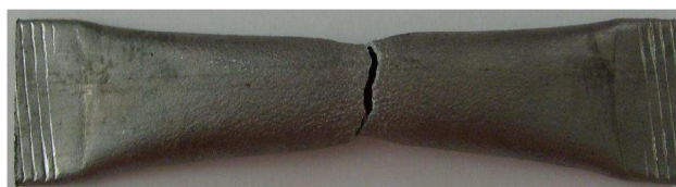
Obr. 19 - Vzorek materiálu po zkoušce na tahovém hydraulickém stroji \phi 18 x 1,5 mm (současný dodávaný materiál)
