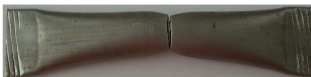
Obr. 17 - Vzorek po zkoušce na tahovém hydraulickém stroji ø 18 x 1,5 mm (původní dodávaný materiál)
