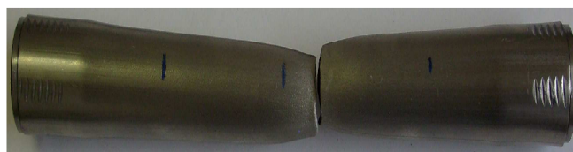
Obr. 21 – Vzorek materiálu po zkoušce na tahovém hydraulickém stroji ø 26 x 1,2 mm
