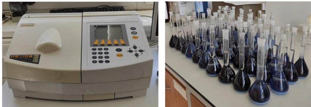
Obr. 42: Spektrofotometr Helios \gamma a vzorky připravené k měření (vytvořeno autorem).
