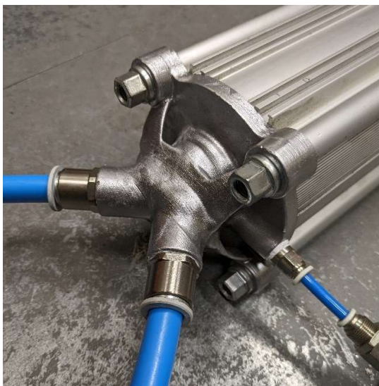
Obr. 29 Montáž čela válce
